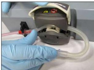
Inserire la parte flessibile del tubo (2) nella testa della pompa e chiudere il coperchio.
